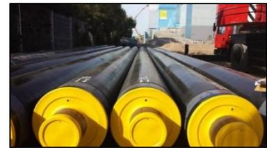
Le réseau fonctionne en **circuit fermé**. Il est constitué d'une double canalisation : l'une pour conduire le fluide vers les sous-stations, l'autre pour assurer son retour vers les équipements de production.
